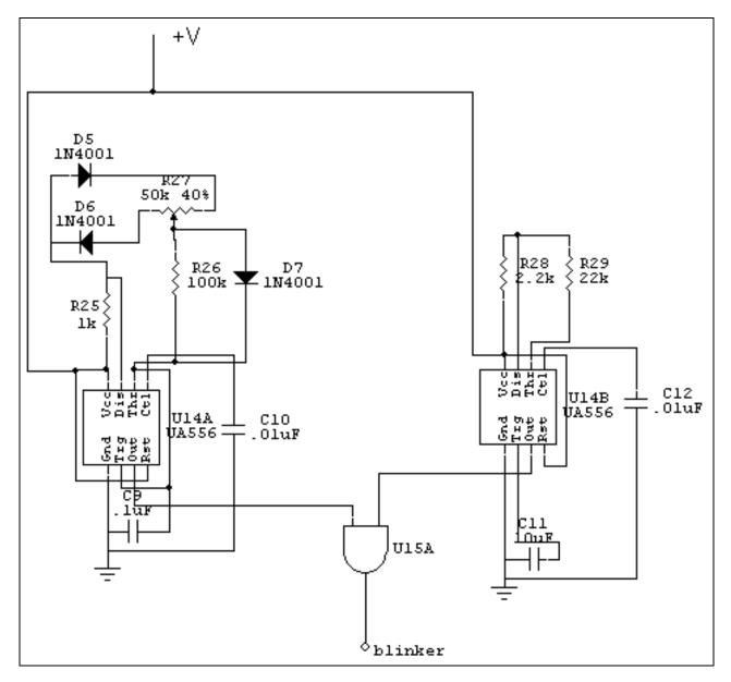
Fig. 20.4. Light Control Circuit.
